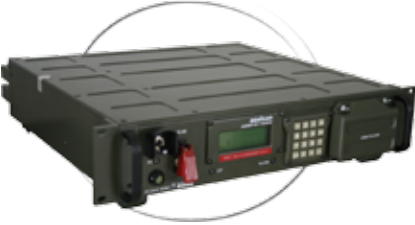
Anahtar Dağıtım Terminali
